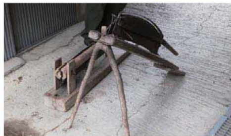
カヤを裁断するオシギリ(カイバ)。傾斜畑でも刃を水平に保ち、作業効率を上げるために脚が付いている
